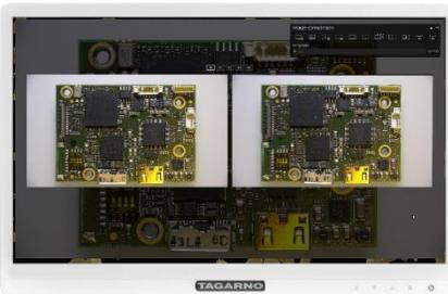
**画像比較** 参照とサンプル画像マッピングや参照とサンプル画像の左右表示比較が可能又、参照画像とサンプル画像の重ねた画像の左右割合可変比較も可能
