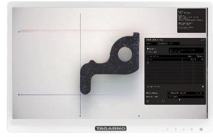
**検証線** 製品に合わせて、水平線と垂直線又許容範囲線を設定し、装置サイズに合わせて保存。呼び出して製品の検品に使用。
