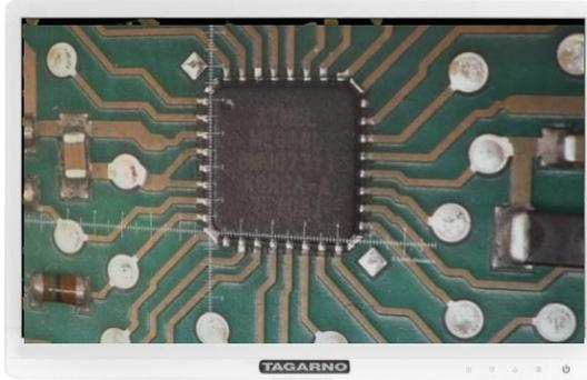
**ルーラーの表示** 垂直、水平又は両方のルーラーを表示可能。倍率に応じてスケールは自動的に変動します。サンプルに応じて色も変更可能。
